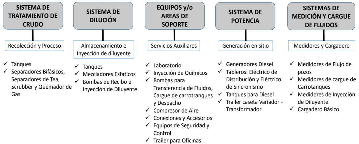
Figura 15. Elementos Tipo Operativos para la Facilidad Temporal de Superficie del campo en estudio.
