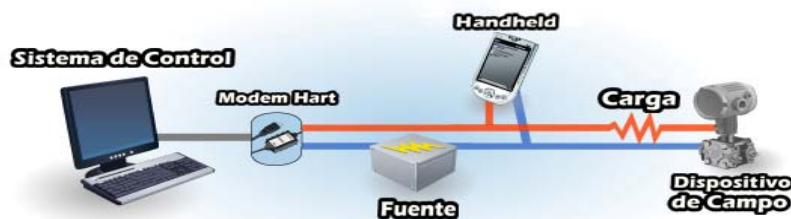
Figura 5 Modo de conexión punto – punto:
