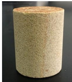
Figura 7. Registro fotográfico de una de las Bereas, utilizada en los Coreflooding.
