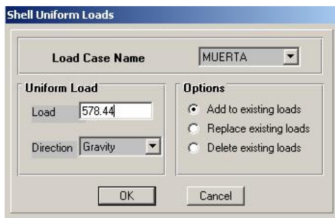
Figura 2-11. Aplicación de cargas sobre el elemento shell
