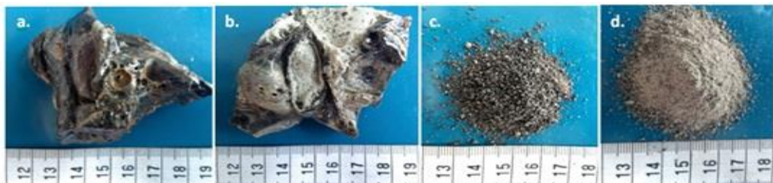
Figura I.c Escoria obtenida en el proceso de fundición a) Escoria obtenida directamente del proceso sin inclusión de pilas. b) Escoria obtenida directamente del proceso con inclusión de pilas. c) Escoria pulverizada sin pilas. d) Escoria pulverizada con pilas.
