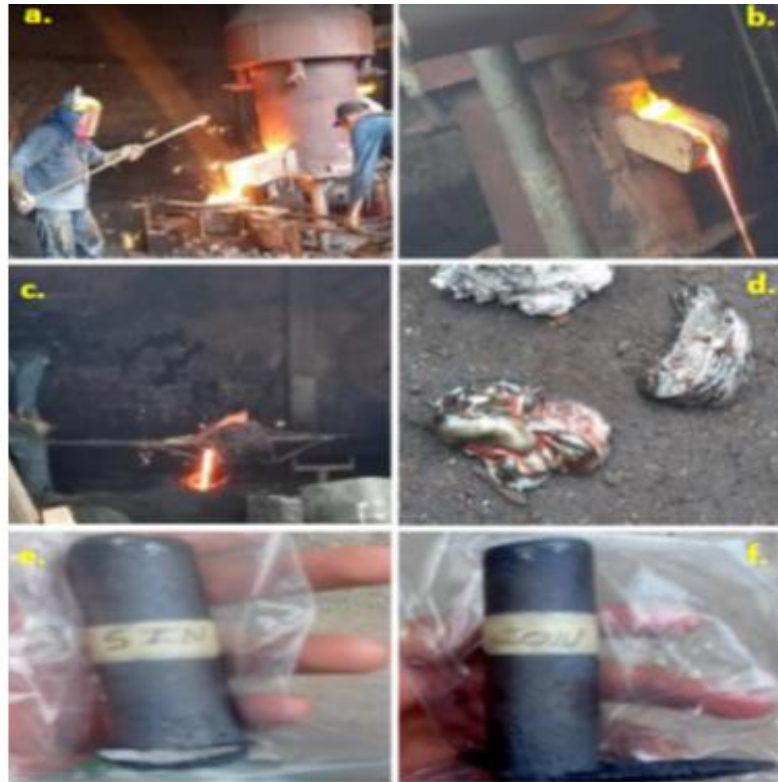
Figura I.b Secuencia del proceso de fundición y obtención de las probetas y la escoria a) Operarios obteniendo la colada b) Piquera de escoria c) Vertimiento de la colada d) Trozos de escoria e) Probeta obtenida de la fundición sin la inclusión de pilas
