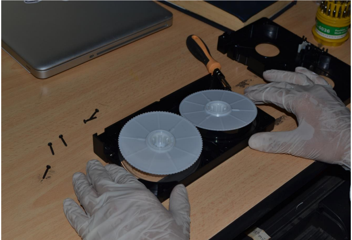
Imagen 10. Limpieza interna de soporte en VHS
