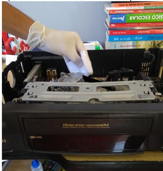
Imagen 12. Limpieza de cinta contaminada en rebobinado para cambio de empaque
