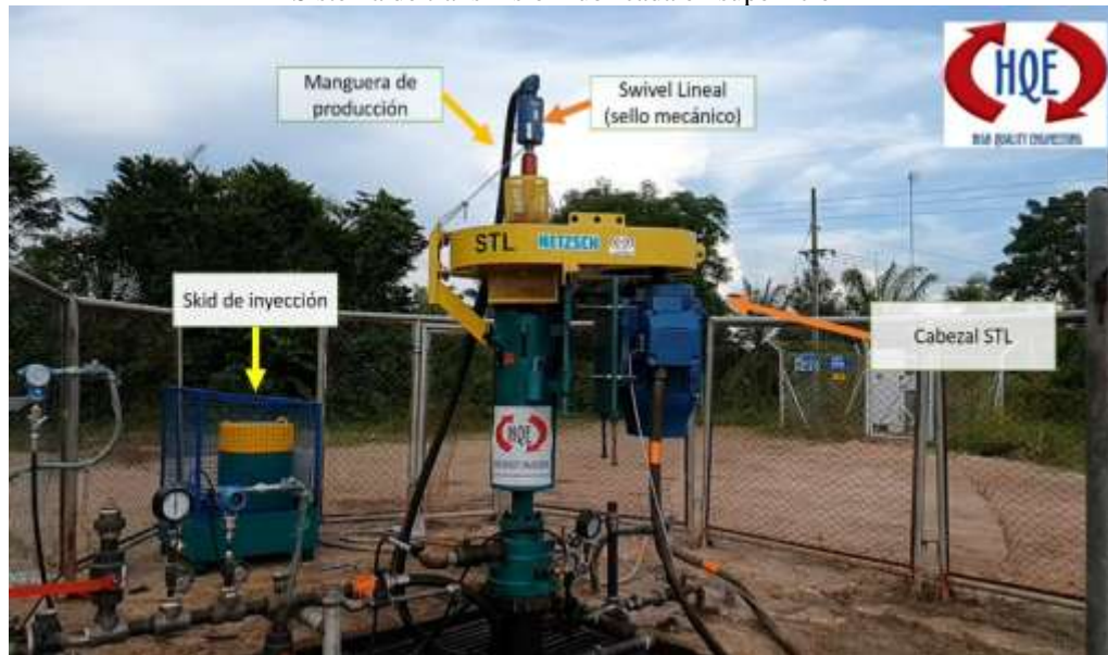
Ilustración 8 Sistema de transmisión lubricada en superficie
