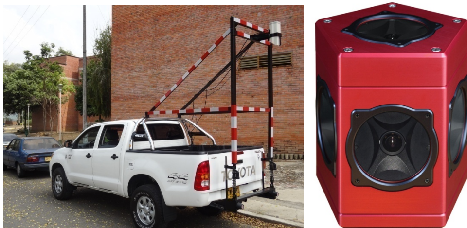
Figura 7. Fotografía de montaje cámara lineal y cámara ladybug 3
