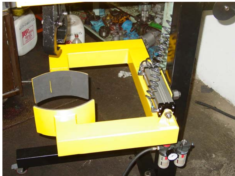
Figura 38. Aspecto final del sistema de sujeción de los cilindros.
