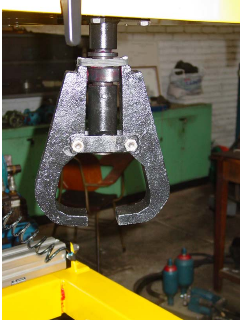
Figura 35. Aspecto final del sistema de sujeción de las válvulas.
