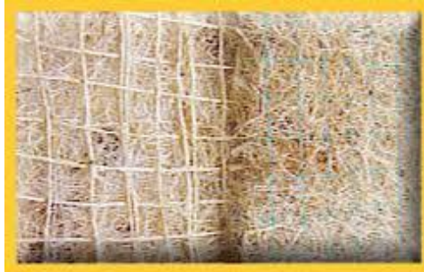
Figura 7. Mantos temporales para combatir la erosión. Agromanto
