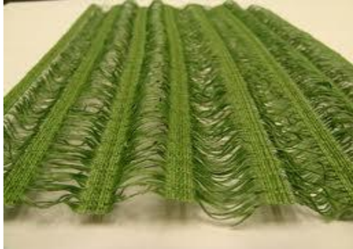
Figura 9. Mantos permanentes para combatir la erosión.
