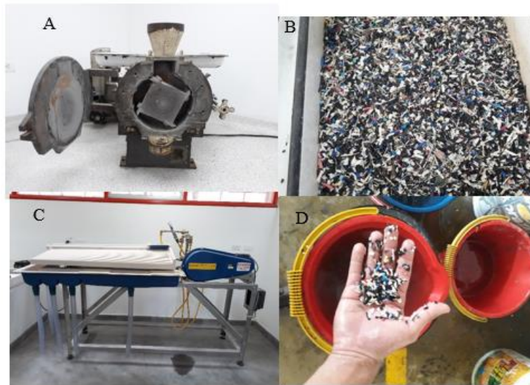
Figura 7. A) Trituradora de cuchillas. B) Material luego se liberación total. C) Mesa Wilfley. D) Material polimérico separado.
