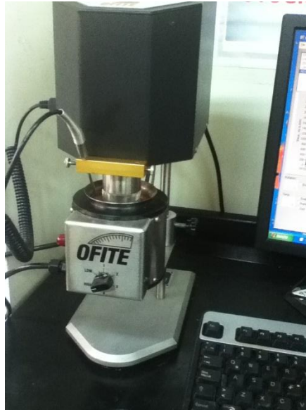
Figura 22. Viscosímetro digital Brookfield
