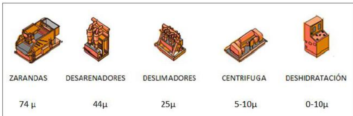
Figura 3. Equipo de control de solidos
