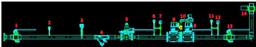
Figura 25. Subsistema tren de gas natural
