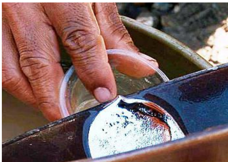
Foto 1: Utilización del mercurio para la extracción de oro
