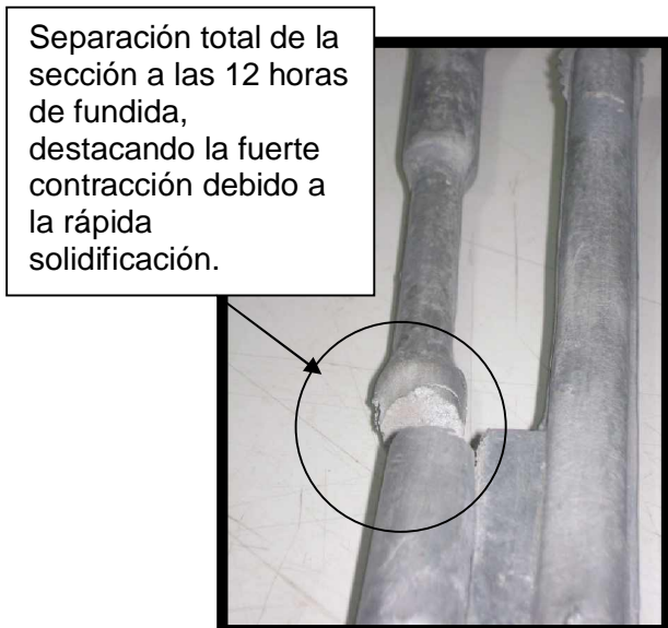
Figura. 31 Rotura en la sección de empalme, filete a 90°.
