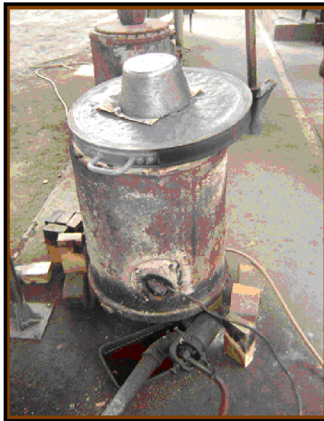
Figura 22. Horno de Fusión con combustible ACPM.
