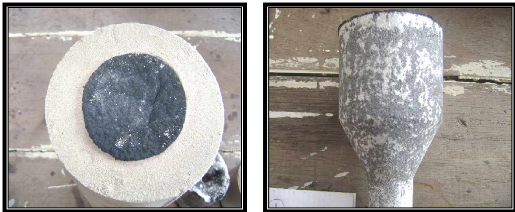
Figura 33. Presencia de manchas negras sobre la superficie de las probetas coladas en arena.
