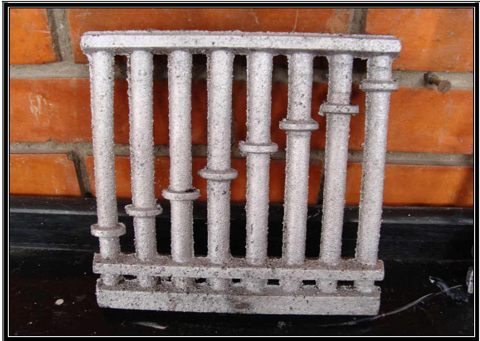
Figura 71. Probeta de agrietamiento en caliente de la Aleación B1(Al 10Mg).
