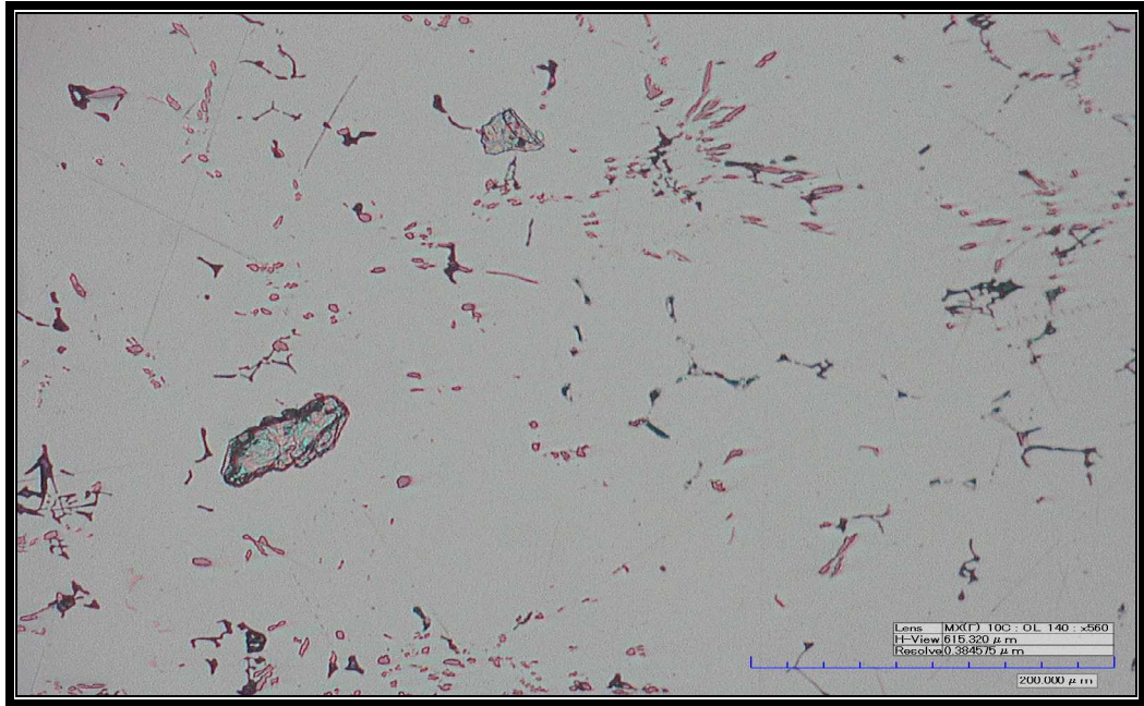
Figura 48. Microestructura de la aleación T1-B14.560x sin ataque. Se observa la fase Mg_2Si (letra china). La fase Al_6(FeMn) , se encuentra en forma ovalada. El eutéctico Mg_5Al_8 , no se encuentra visible.
