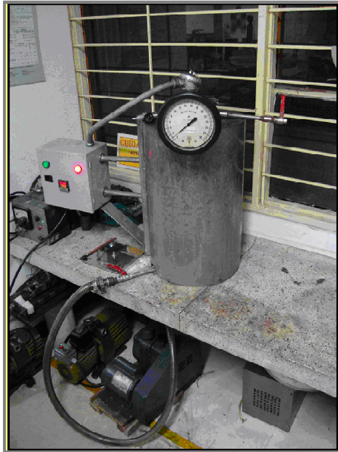
Figura. 28 Horno para solubilización con bomba de vacío, presión 1 psi.
