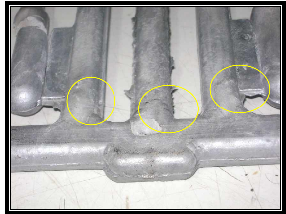
Figura. 30 Detalle de puntos críticos, zona de unión, flujo ascendente de metal.
