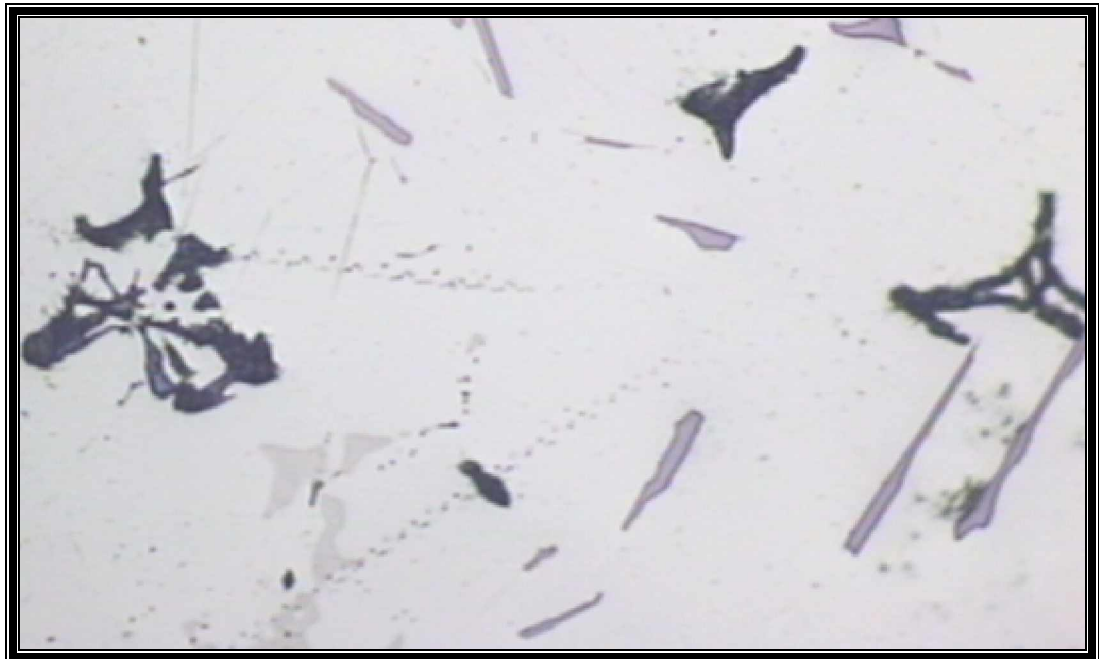
Figura 45. Microestructura de la aleación T1-A16 560x sin ataque. Se observan la fase Mg_2Si (letra china). La fase Al_6(FeMn) se encuentra en forma de agujas. El eutéctico Mg_5Al_8 , se hace visible (color blancuzco que se confunde con la matriz).
