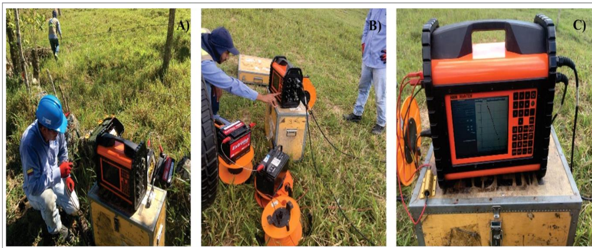
Figura 8. A. Campañas de campo de adquisición de datos SEDT, en el municipio de Mogotes. B. Campañas de campo de adquisición de datos SEDT, en el municipio de Barichara. C. Equipo de adquisición de SEDT, WalkTEM .
