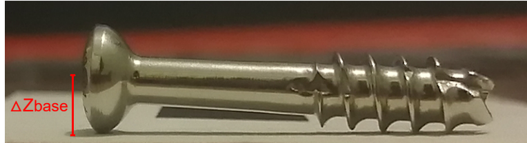
Figura 34. Desfase entre el tornillo y la hoja del patrón de calibración \Delta Z_{base} .
