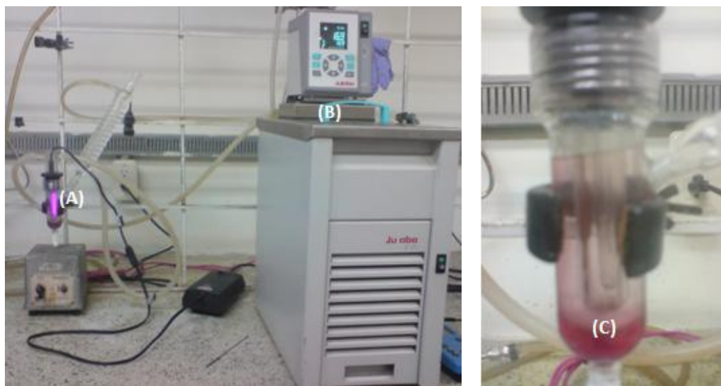
Figura 4. Equipo usado para la síntesis fotoquímica de AuNP estabilizadas por citrato. (A) micro reactor, (B) baño termostático y (C) producto de AuNP estabilizadas con citrato.
