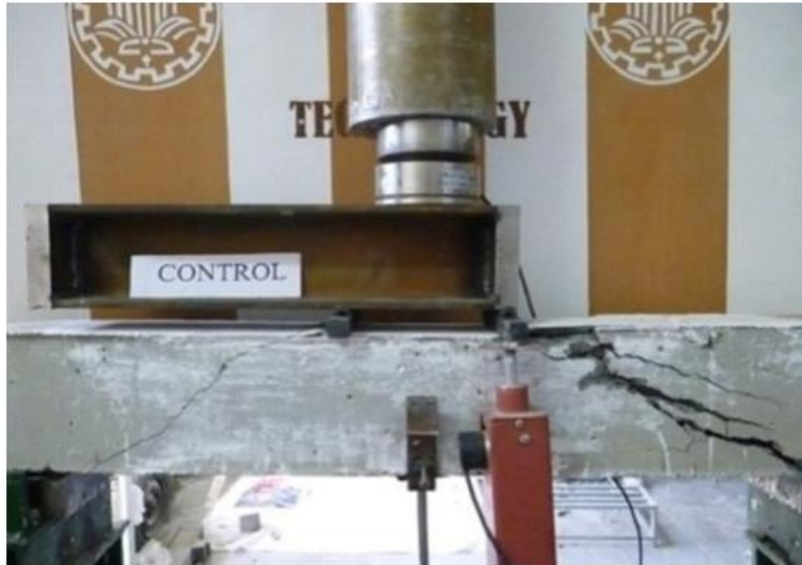
Figura 46. Modo de falla de la viga control sin refuerzo de CFRP.
