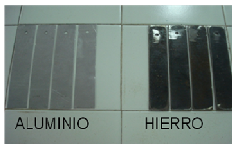
Figura 26. Electrodos de Hierro y Aluminio para electrocoagulación.
