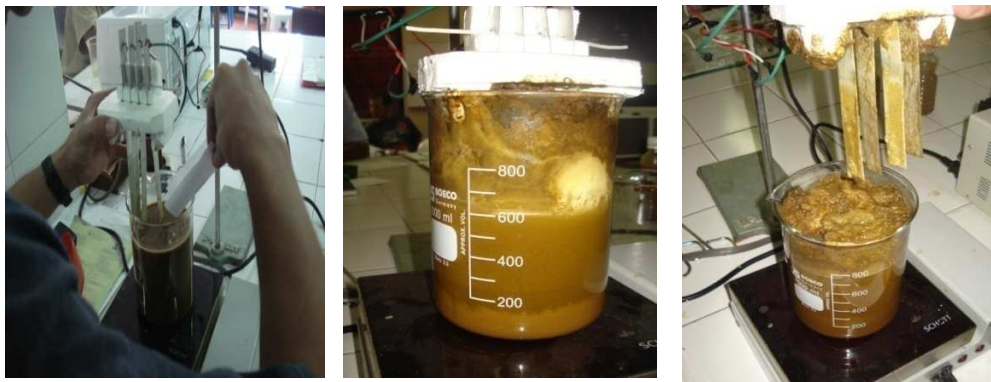
Figura 28. Procedimiento de electrocoagulación para efluentes.
