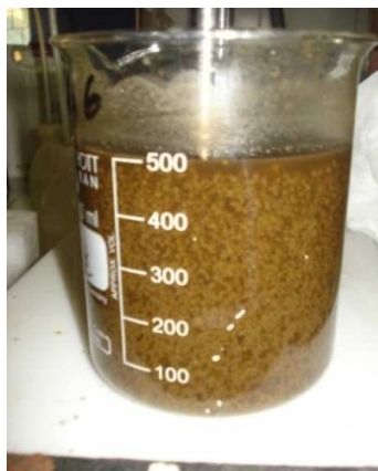
Figura 17. Formación de floculos por adición de polímeros.
