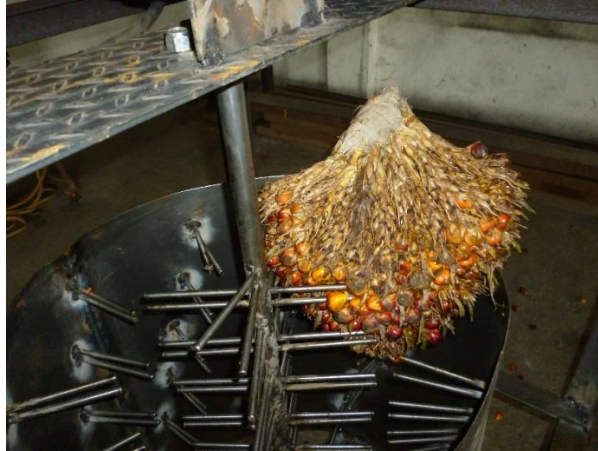
Figura 94. RFF situado entre el eje y el tambor
