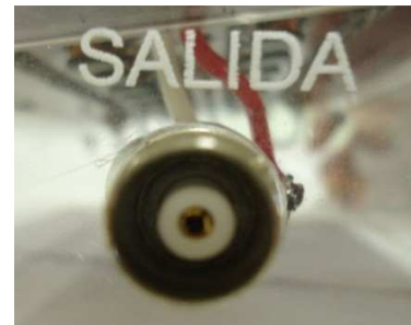
FIGURA 4 Terminales BNC para entrada y salida
