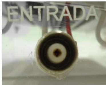
FIGURA 4 Terminales BNC para entrada y salida
