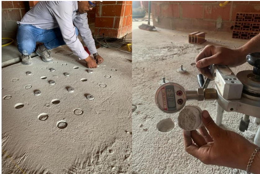
Figura 21. Ensayo de tracción en contrapiso
