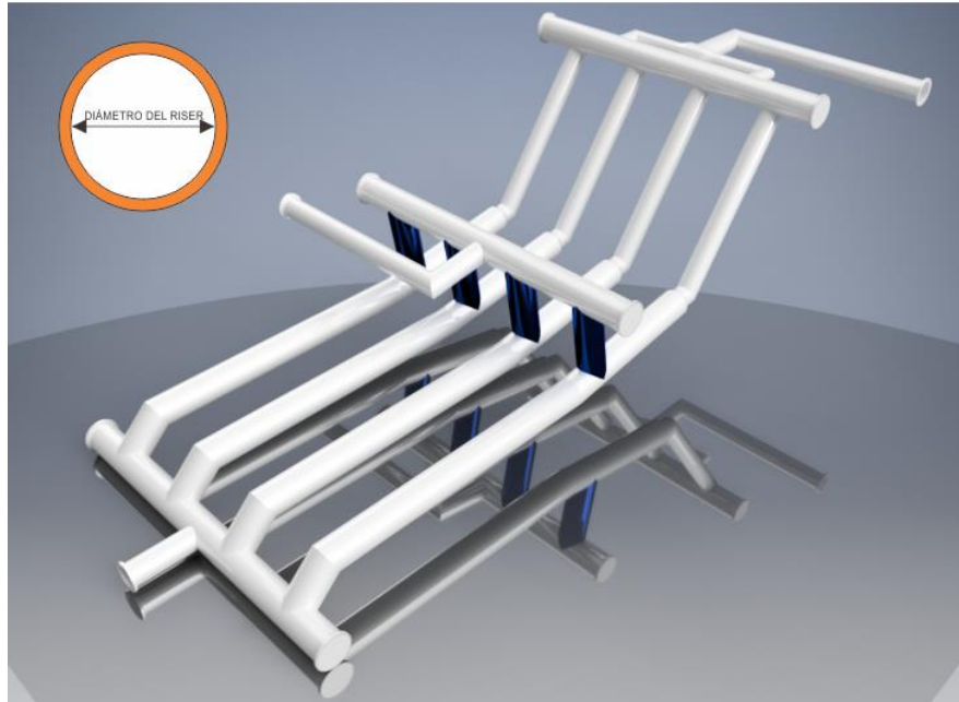
Figura 51. Gas riser de un slug catcher tipo dedo, vista isométrica.
