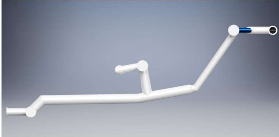
Figura 42. Splitter de un slug catcher tipo dedo, vista lateral.
