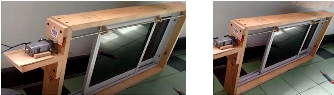
Ilustración 34. Primer modelo mecánico de apertura y cierre de ventana.
