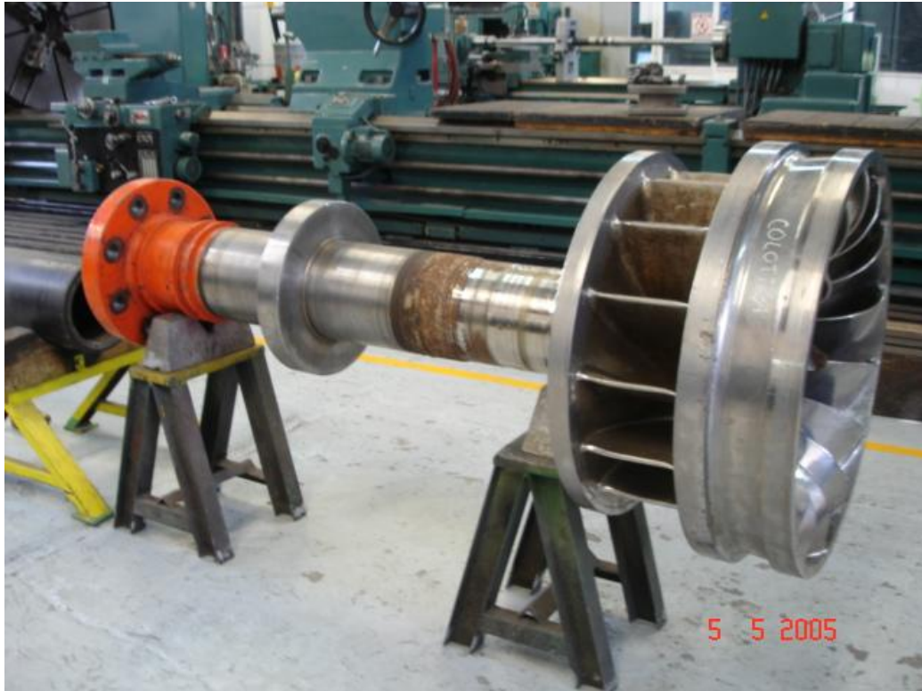
Figura 46. Mantenimiento del rodete y eje de una turbina Francis.
