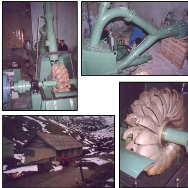
Figura 8. Turbina Pelton de dos inyectores con potencia instalada de 200 kW.
