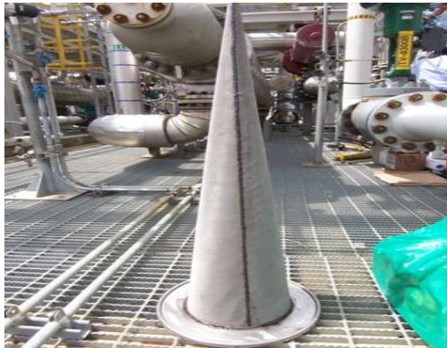
Figura 7. Fotografía del filtro de la succión turboexpander #1, en la planta de gas de Cusiana.
