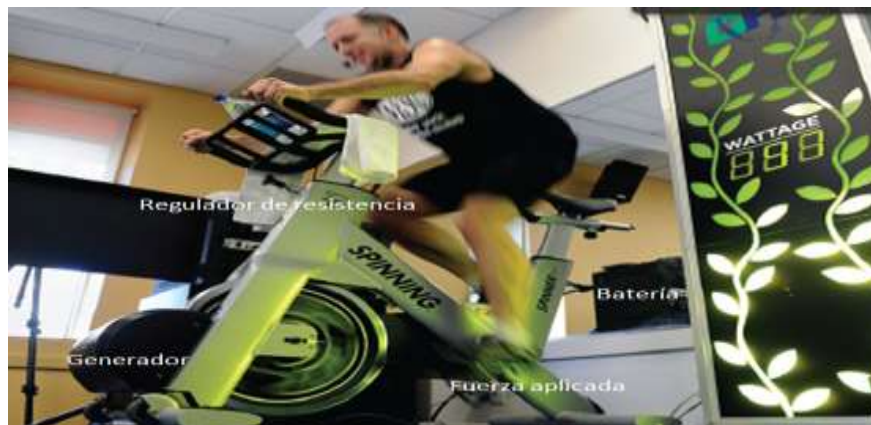
Figura 4. Esquema básico de generación de energía eléctrica a partir de una bicicleta estática.
