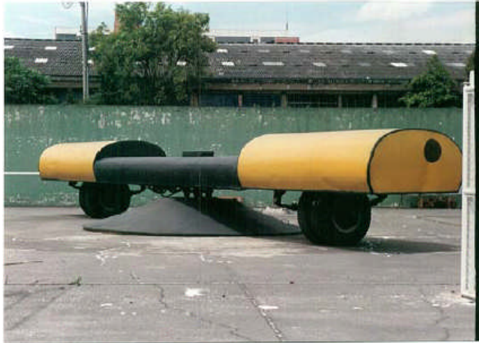
Figura 31 Carrusel de Fatiga, Universidad de Los Andes (Bogotá D.C.)
