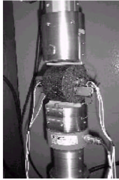
Figura 24. Visualización más cercana del ensayo de la probeta a Tracción Indirecta.
