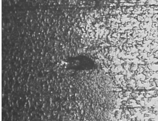
Fotografía 12. Superficie del acero después del ensayo 7 (10%W, 150 \mu m, 3000 rpm)
