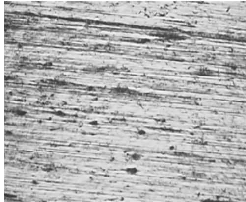
Fotografía 6. Superficie del acero después del ensayo 1 (10%W, 50 \mu m, 1000 rpm)
