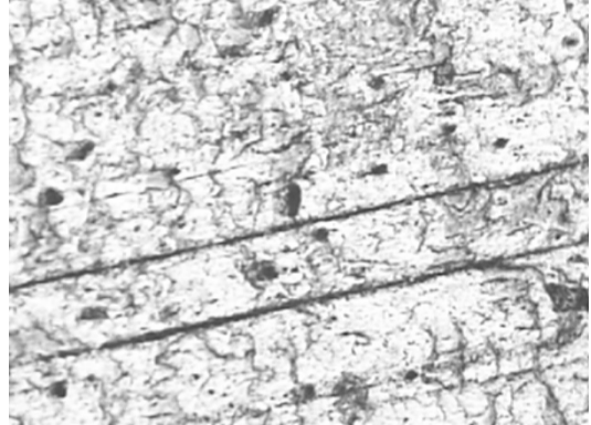
Fotografía 12. Superficie del acero después del ensayo 7 (10%W, 150 \mu m, 3000 rpm)
