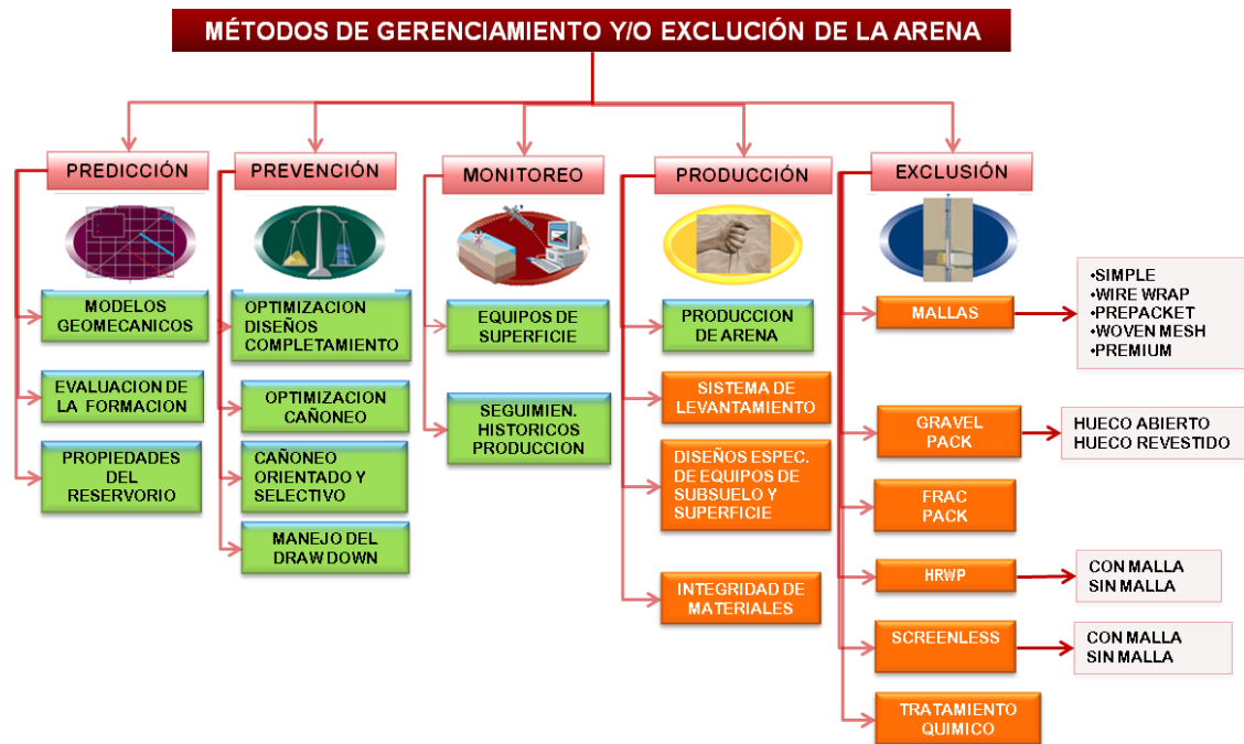
Figura 2 Métodos de Gerenciamiento y/o Exclusión de arena Fuente: Mauel G. Jaimez et al, Metodología de gerenciamiento y/o exclusion de arena, Grupo gerenciamiento de arena, ECOPETROL-ICP 2010.
