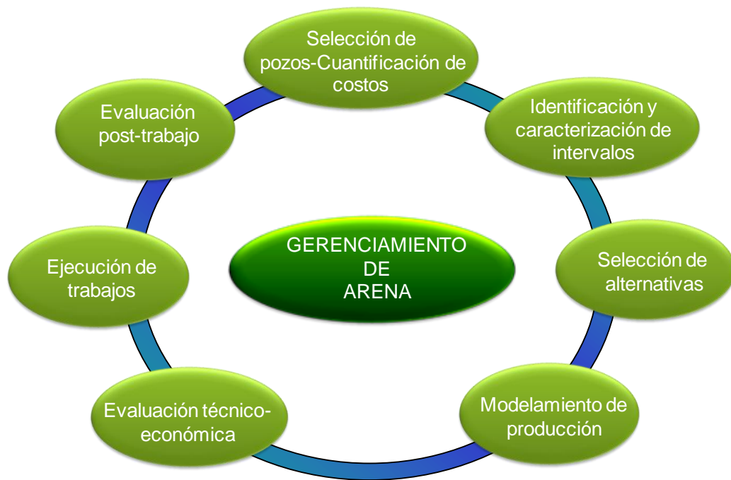
Figura 20 Pasos para desarrollo de la metodología de gerenciamiento y/o exclusión de arena Fuente: Jaimes G. Manuel et al, Incremento de Productividad Mediante Aplicación de Tecnologías de Exclusión y/o Gerenciamiento de la Arena – Campo Colombiano, Grupo de gerenciamiento de arena, ECOPEPETROL-ICP, 2010.
