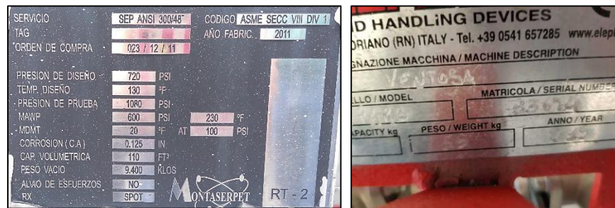
Figura 20. Placa de caracterización de un separador.
