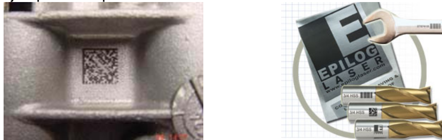
Figura 5. Ejemplo DPM por marca láser
