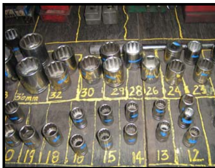
Figura 14. Herramienta con marca del lápiz eléctrico
