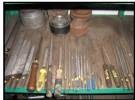
Figura 13. Herramienta con su correspondiente marcación según el estado
