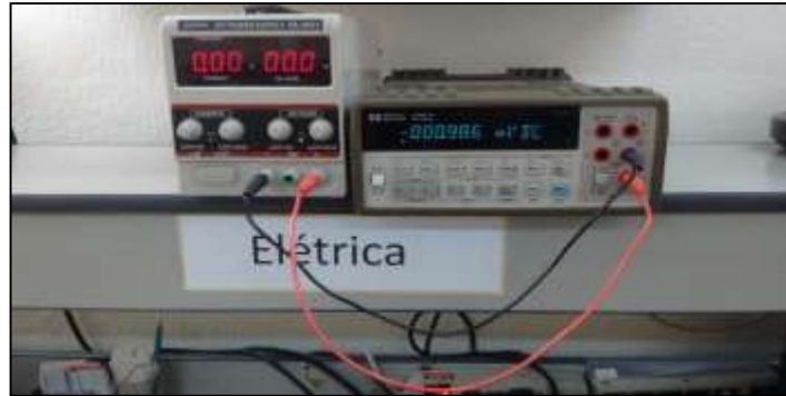
Figura 28. Conexión del multímetro patrón y el equipo sometido a calibración.
