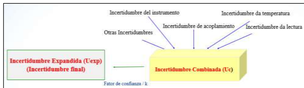
Figura 2. Atribuciones de incertidumbre en la calibración de equipos de medición de energía eléctrica 46 .
