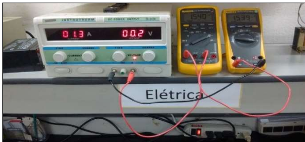
Figura 20. Esquema para calibración de corriente DC mayor a 2 A.
