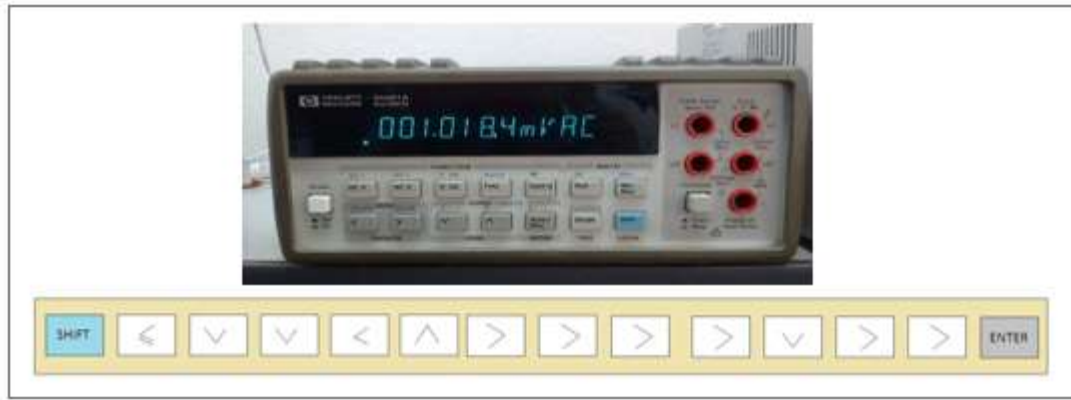
Figura 13. Configuración del multímetro patrón (HP 34401)
