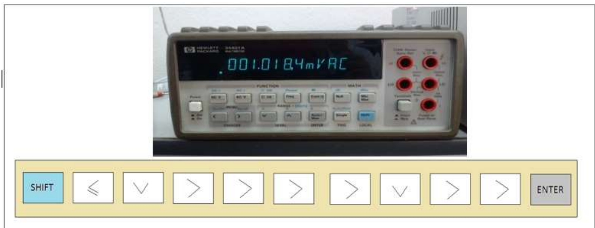
Figura 11. Configuración del multímetro patrón (HP 34401)
