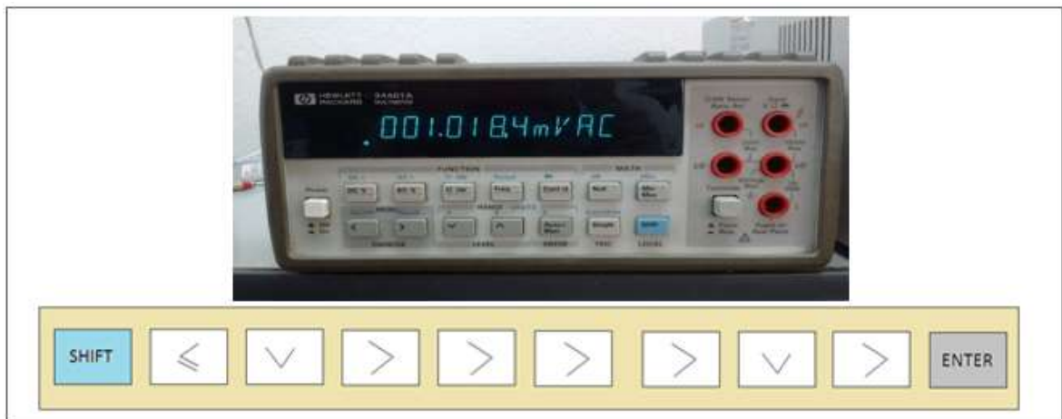
Figura 27. Configuración multímetro patrón HP 34401, corriente eléctrica DC.
