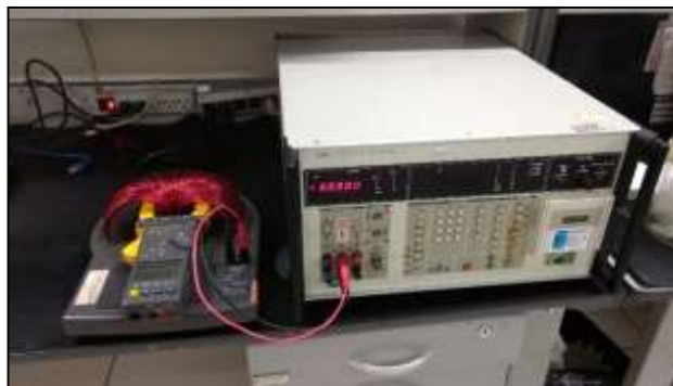
Figura 25. Conexión para la calibración de Corriente Eléctrica AC < 2[A] con medidor a calibrar.
