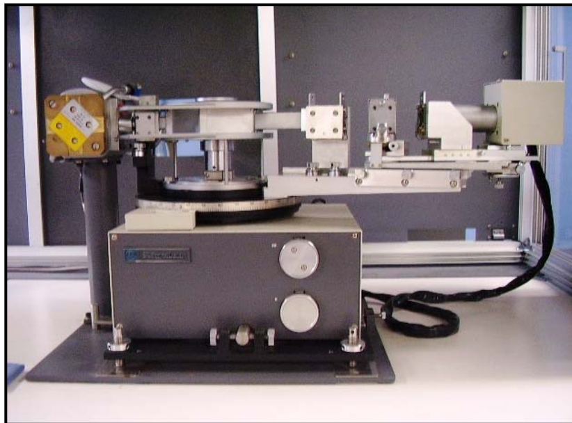
FIGURA 3: Aspecto de difractómetro marca RIGAKU modelo D/MAX III B. Laboratorio de Difracción de Rayos X. Escuela de Química, UIS.
