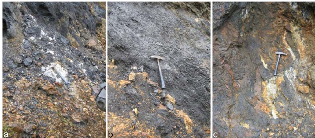
FIGURA 26: Aspecto de la intercalación de rocas presente en el corte del sector “Las Cruces”. a. vena de minerales poco cohesivos, principalmente albita-dolomita-calcita, en contacto con lodolita carbonosa (muestra COR-34-05); b. lodolita carbonosa muy replegada (muestra COR-34-06); c. bolsa de minerales poco cohesivo con una textura brechoide (muestra COR-34-07).
