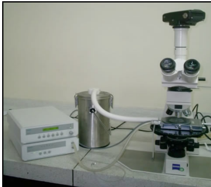
FIGURA 4: Aspecto de la platina de calentamiento-enfriamiento TH600, marca LINKAM, localizada en el laboratorio de microtermometría de la escuela de Geología. UIS-Sede Guatiguará.
