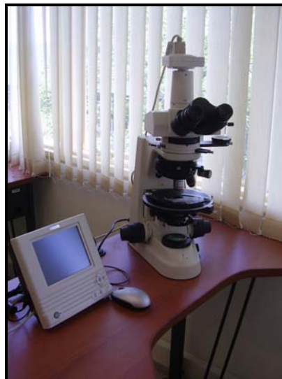
FIGURA 2: Aspecto del microscopio de luz transmitida Nikon Eclipse-50i con cámara fotográfica DS-L1. Laboratorio de Microscopía Óptica. Escuela de Geología. UIS
