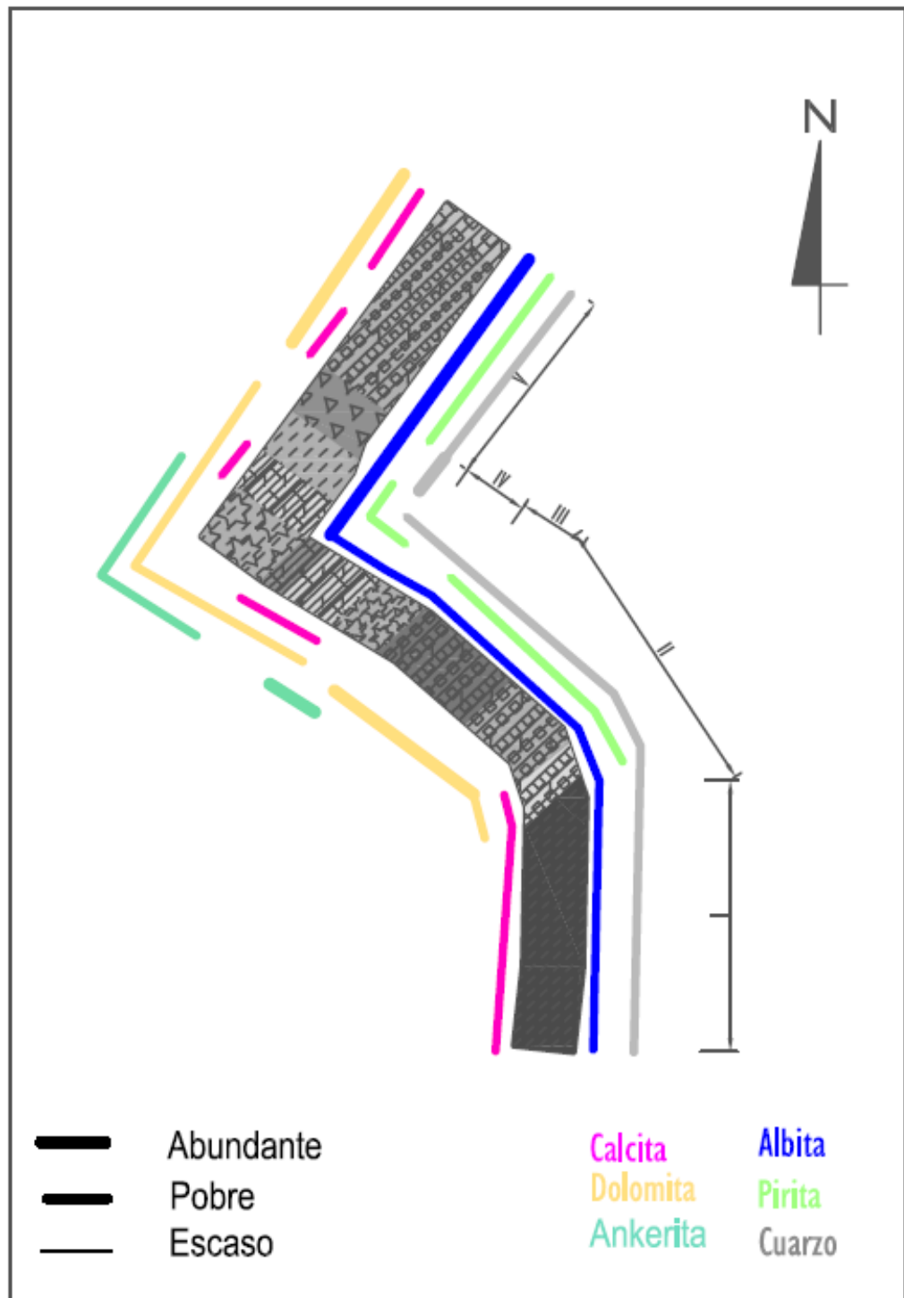
FIGURA 44: Zonalidad a nivel cualitativo y semicuantitativo encontrados en el túnel “LAS CRUCES”
