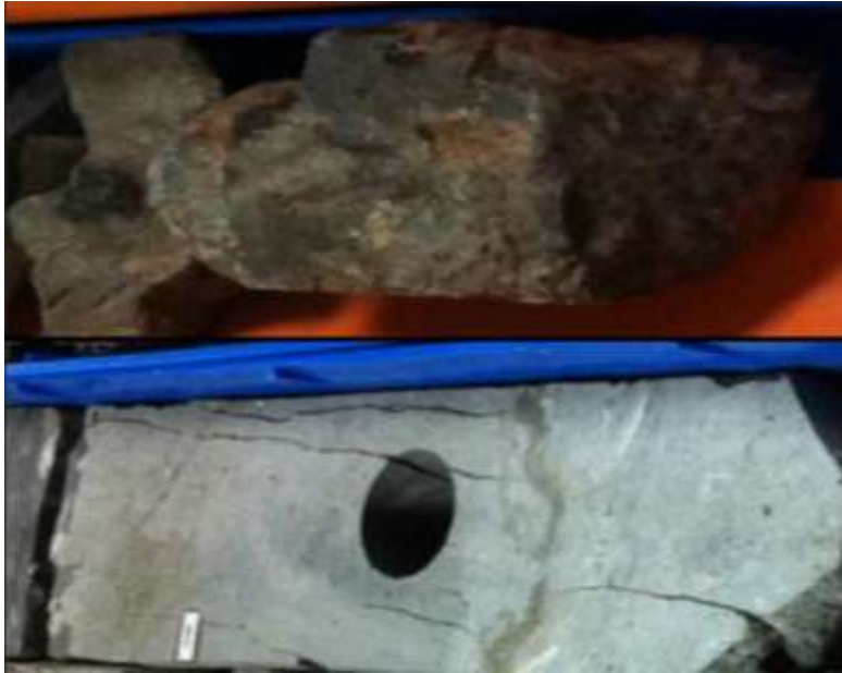
Figura 49. Facies Wackestone fracturado y con grietas de disolución, Orito-105, 6596 ft, y Orito-5, 5000 ft.
