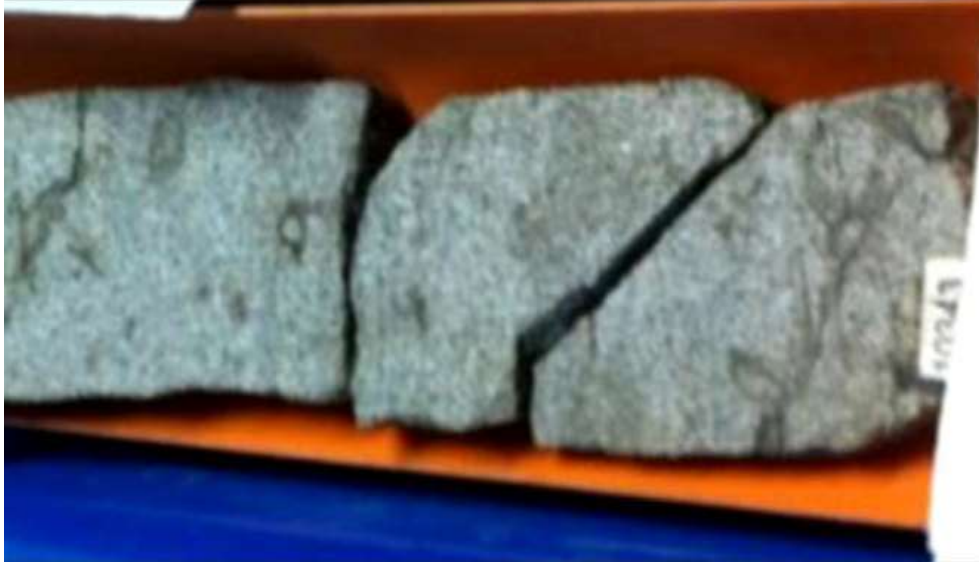
Figura 64. Arenisca fina a media, con estratificación cruzada. Acae-1, 10343 ft.
