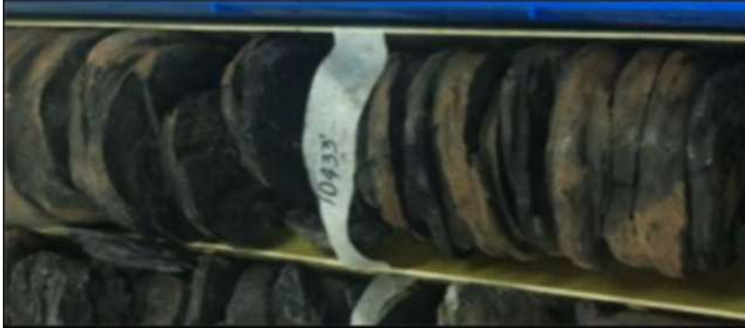
Figura 46. Fácies Lutita negra fósil. Hormiga 1X, 10433 ft.
