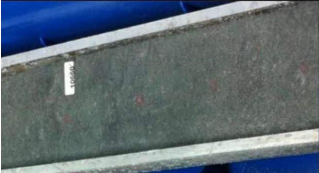
Figura 50. Facies Arenisca glauconítica: Arenisca de grano fino a medio con Glauconita sin estructura. Loro-12D, 10660 ft.
