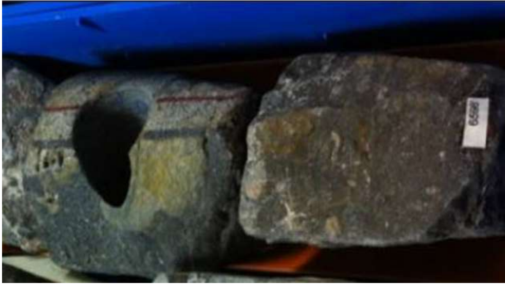
Figura 61. Arenisca con fracturas rellenas de calcita, 6558ft.
