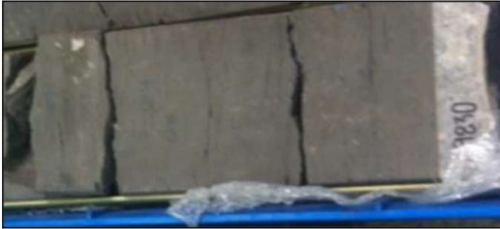
Figura 44. Facies Mudstone Calcáreo, pozo Hormiga 1X, 9830 ft.
