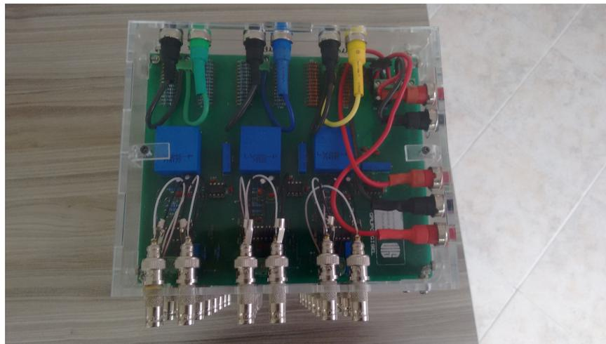
*Figura 50.* Imagen de circuito impreso con el transductor de tensión LV25-P y amplificador operacional OP470.
