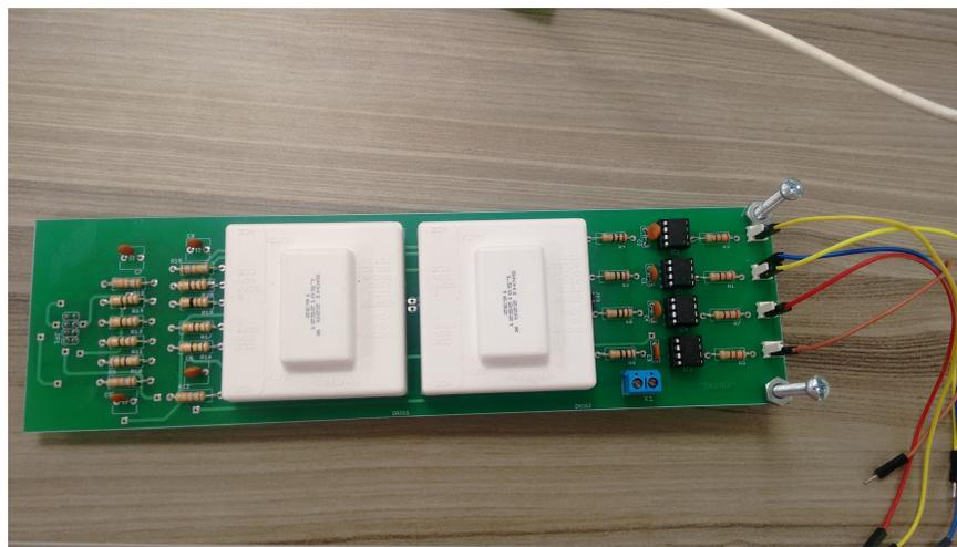
Figura 49. Imagen de circuito impreso realizado con el driver HCPL 3120 y driver SKHI 22AR.
