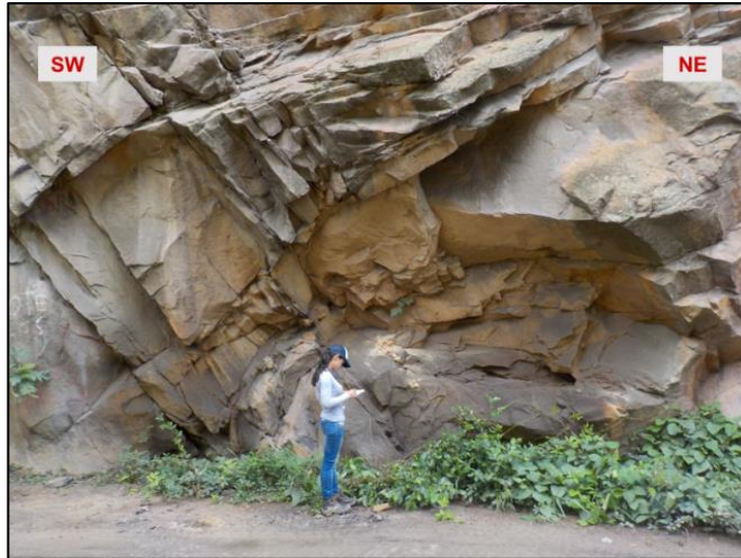
Fotografía 20. Areniscas de la Formación Mirador (E2m). Orientación S55W-N55E. Coordenadas: 1157135 m E, 1376987 m N, 240 msnm.
