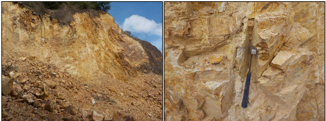
Fotografía 7. Afloramiento de roca metamórfica de tipo cuarcita de la Formación Silgará perteneciente a la estación CZ-47.
