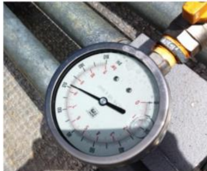
Figura 29. Prueba de hermeticidad con aire.
