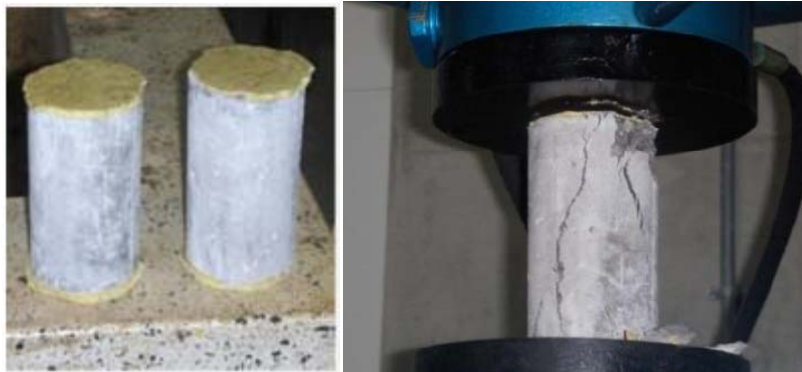
Figura 28. Pruebas de compresión
