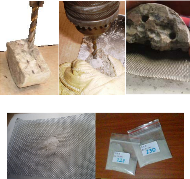
Figura 38. Extracción de muestras para perfil de concentración
