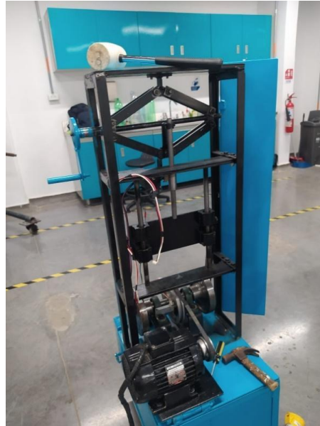
Figura 1. Bastidor de banco de análisis de resortes.
