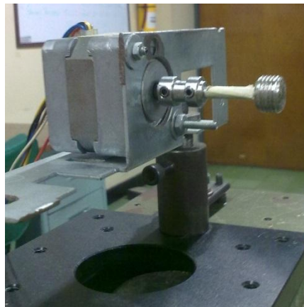
Figura 10. Cámara de ablación.
