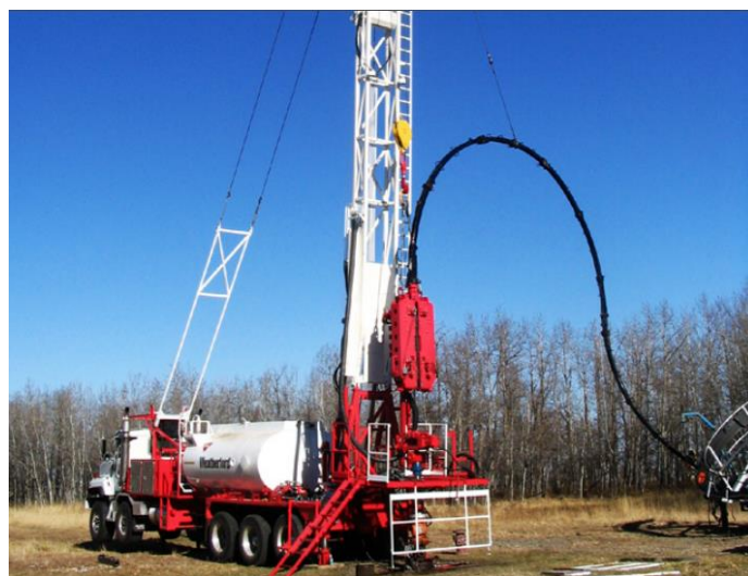
Figura 6. Unidad Flushby con Mobile Gripper para corrida de varilla continua en pozo
