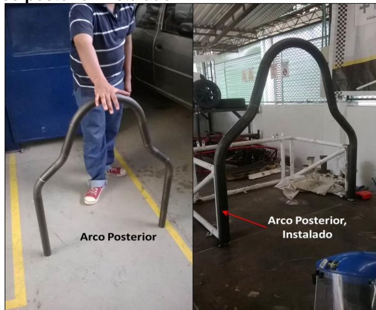
Figura 172. Arco posterior Instalado.
