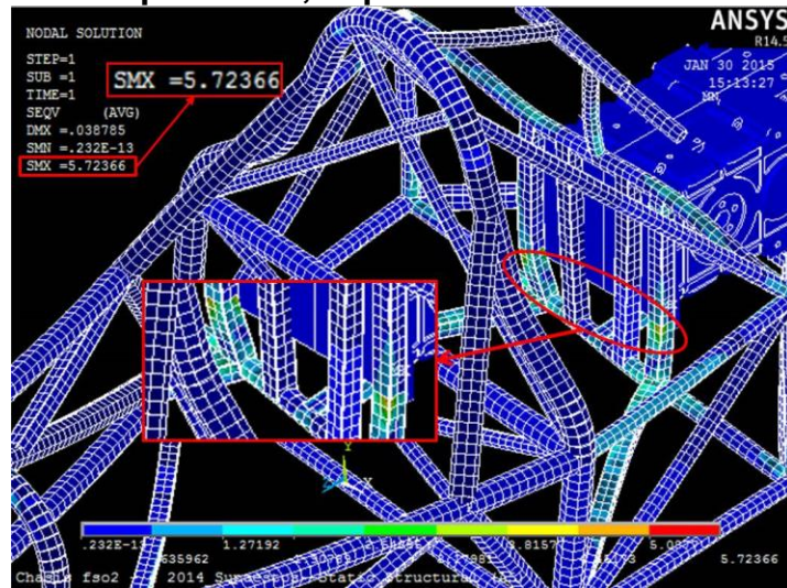
Figura 158. Esfuerzo equivalente, supuesto “Curva”. Chasis FSO2-e 2014.
