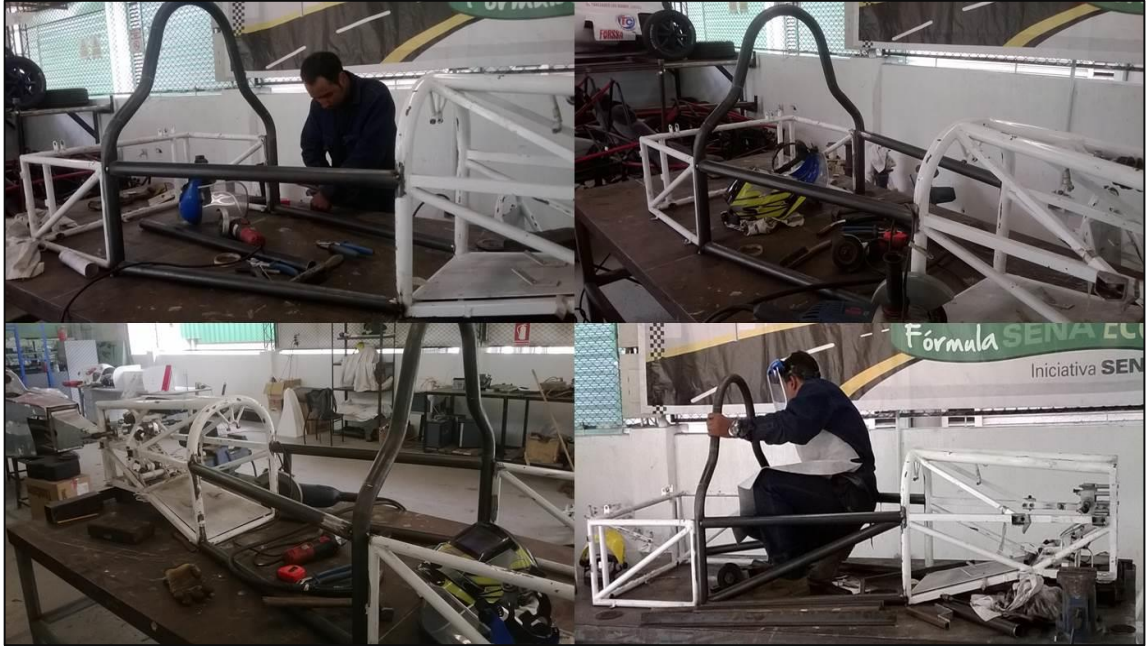
Figura 173. Instalación de los miembros laterales.
