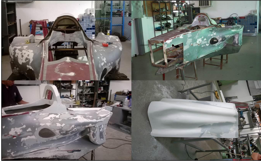
Figura 178. Trabajos de adecuación de la carrocería.
