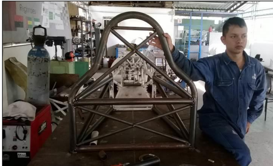
Figura 174. Instalación de los refuerzos del arco posterior.
