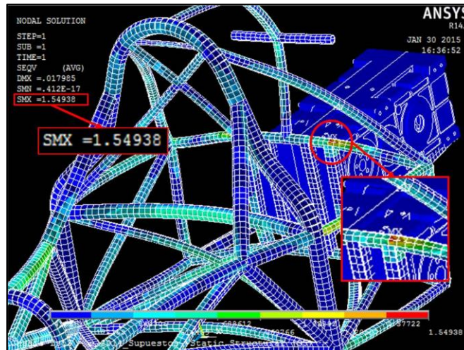
Figura 153. Esfuerzo equivalente, supuesto “Aceleración”. Chasis FSO2-e 2014
