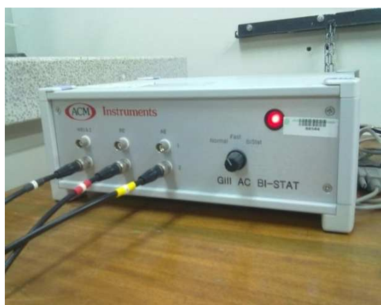
Figura 10. Bipotenciostato ACM Instruments utilizado en las mediciones electroquímicas.
