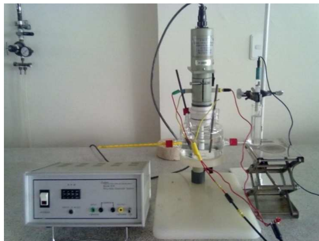
Figura 8. Celda electroquímica- ECR con inmersión de los electrodos de trabajo, auxiliares y de referencia, en solución de HCl 0,5 M a 25°C - 1500 RPM (condiciones dinámicas).
