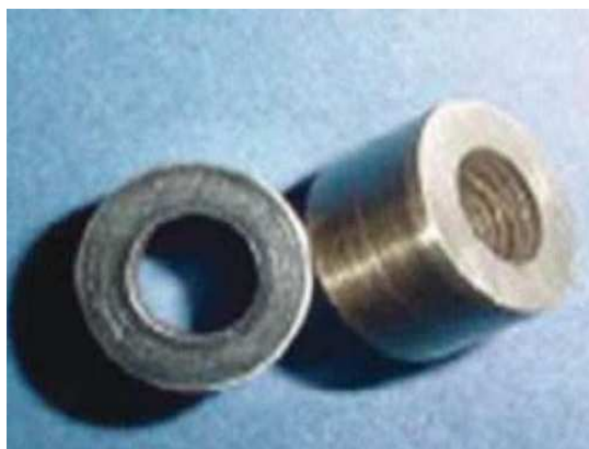
Figura 6. Forma de las probetas metálicas para la realización de las pruebas de corrosión
