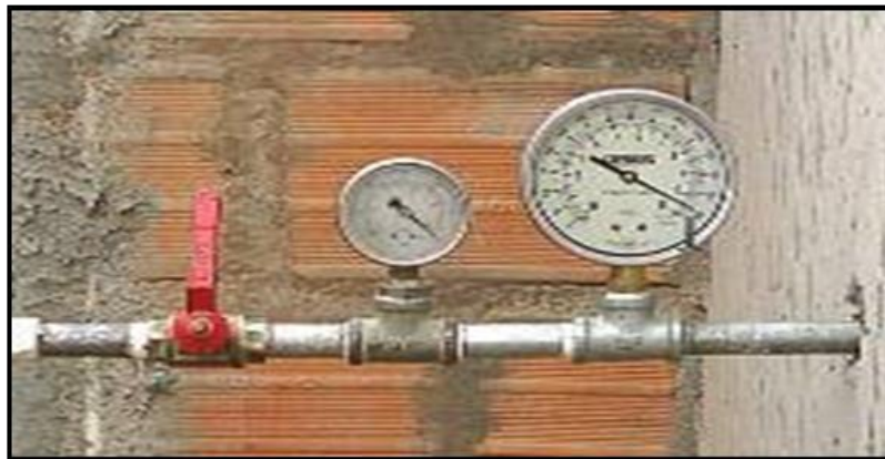
Figura 25. Prueba de Hermeticidad, Fuente: Registro Fotográfico TAYRONA II
