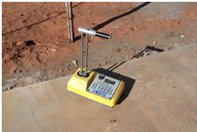
Figura 10. Densímetro Nuclear, Fuente: El autor
