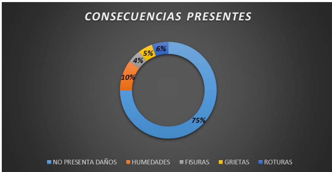
FIGURA 91. Consecuencias presentes en las estructuras en Rincón de la Paz
