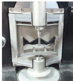
Figura 15. Deformación plástica de la probeta después de 30000 ciclos de carga
