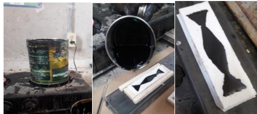
Figura 10. Proceso constructivo de los Especímenes.
