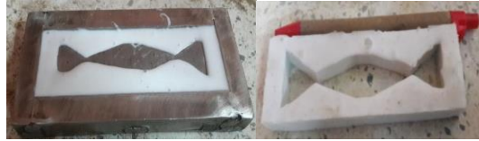
Figura 9. Proceso de fabricación de los moldes en Caucho Silicona
