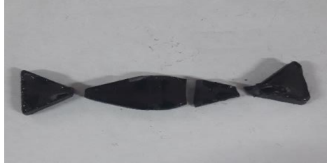
Figura 13. Probeta de asfaltita fracturada
