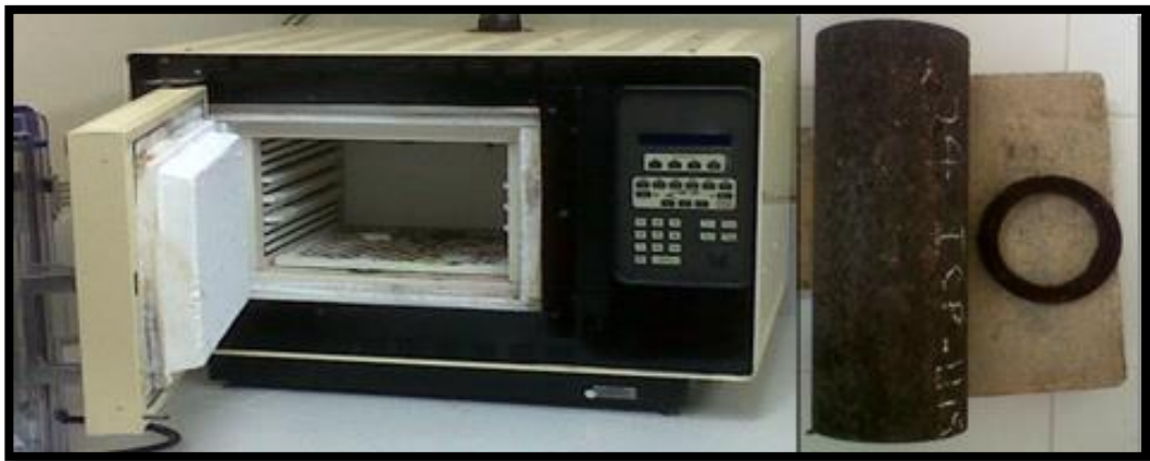
Figura 8. Mufla NEY 6-1350A y cupones del acero 1.25Cr – 0.5Mo
