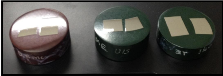
Figura 7. Muestras del acero 1.25Cr – 0.5Mo, montadas en baquelita y preparadas metalográficamente.
