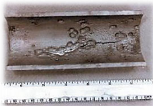
Figura 4. Corrosión localizada por \text{CO}_2 .
