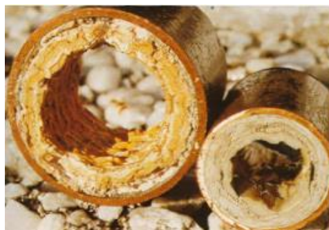
Figura 7. Formación de depósitos en tuberías por presencia de aguas duras.
